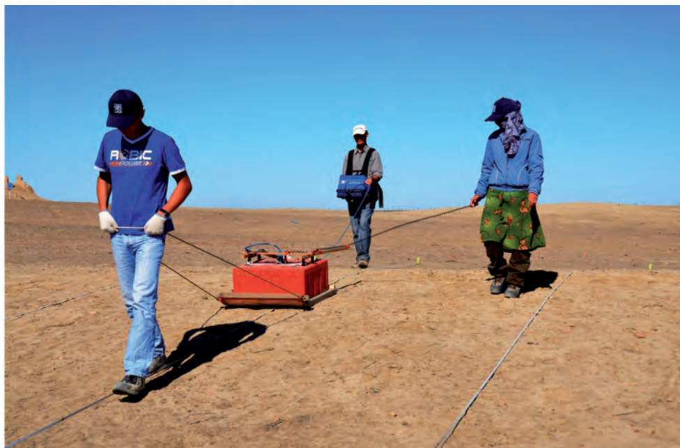
Рис. 7. Городище Сауран. Процесс съемки методом геомагнитного сканирования
