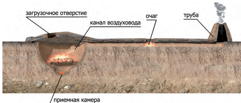
Рис. 3. Трехмерные графические реконструкции теплотехнического сооружения шахтного типа на поселении Атасу
