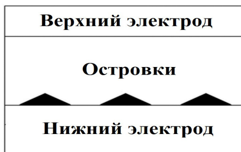
Рис. 1. Схематическое представление структуры мемристора с островковым нижним электродом
