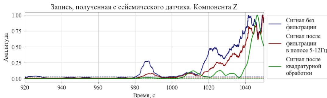
Результат работы алгоритма обнаружения движущегося грузового поезда по акустическим колебаниям
