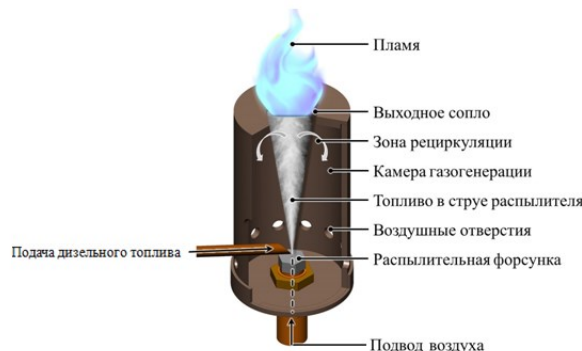
Рис 1. Схема горелочного устройства.
