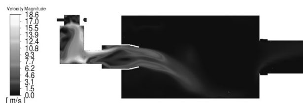
Рис. 2 Магнитуда скорости в тангенциальном горелочном устройстве и топочной камере.
