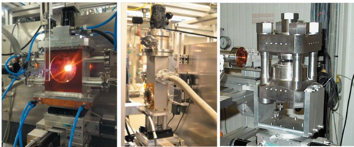
Рисунок 27. Слева — вакуумная камера для ячеек высокого давления с резистивным нагревом, в центре — криостат для ячеек высокого давления. Для масштаба: обе установки закреплены с помощью кинематических фиксаторов Newport размером 8×10 см,[53]. Справа — компактный пресс типа «наковальня с лункой» (высота — 30 см).
