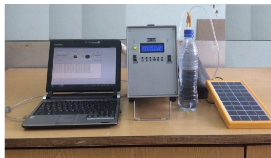
1-rasm. Havodagi, tuproqdagi va suvdagi radiaktiv moddani o'lchash uchun radonometrning tashqi ko'rinishi.
