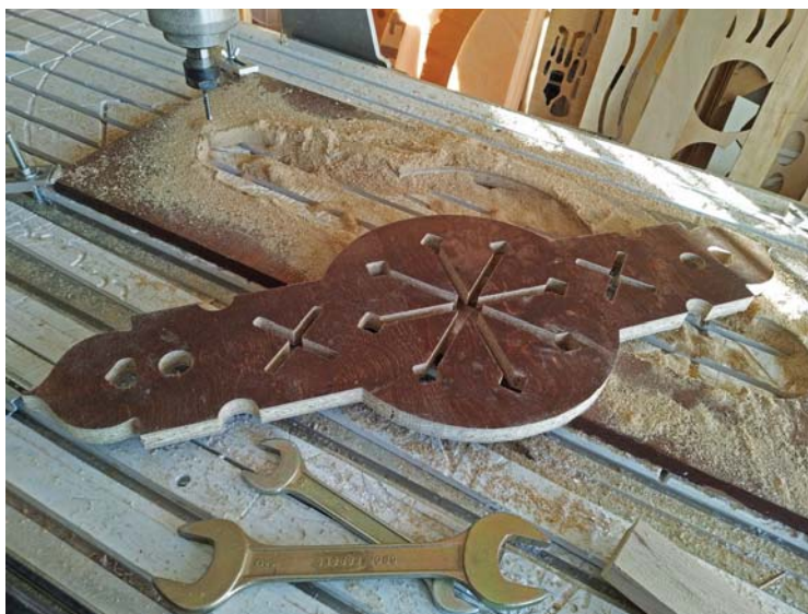
Рис. 5. Элемент декора после прототипирования на ЧПУ-станке.
